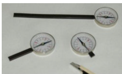
長さ方向着磁では切り口が磁極になる
