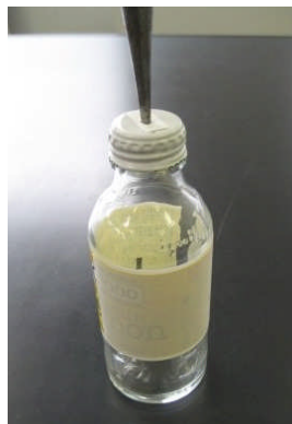
フタの中央にストロー の入る程度の穴を開ける。
